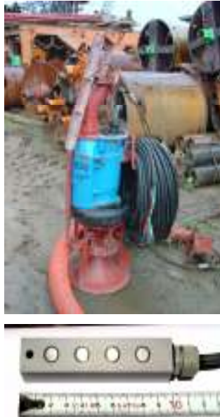
図-1 電気比抵抗試験の方法 写真-1 水中ポンプ(上)と比抵抗センサー(下)
